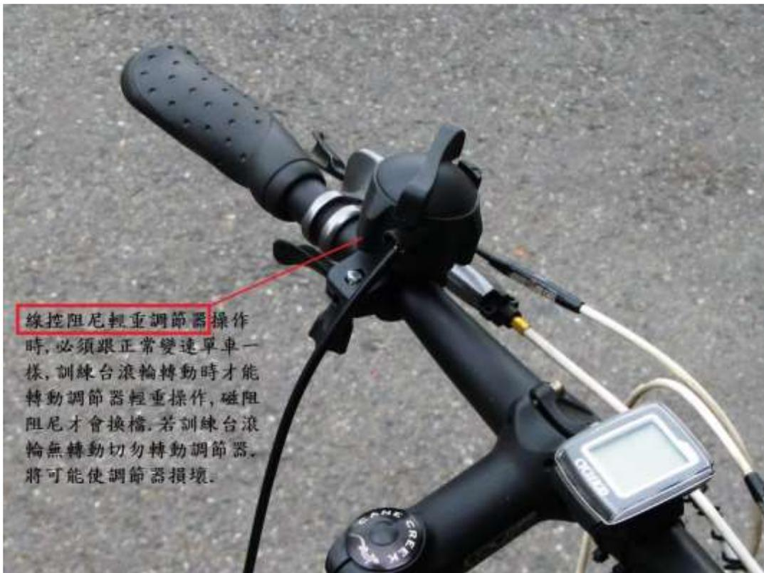
線控阻尼輕重調節器操作時,必須跟正常變速單車一樣,訓練台滾輪轉動時才能轉動調節器輕重操作,磁阻阻尼才會換檔,若訓練台滾輪無轉動切勿轉動調節器,將可能使調節器損壞。
