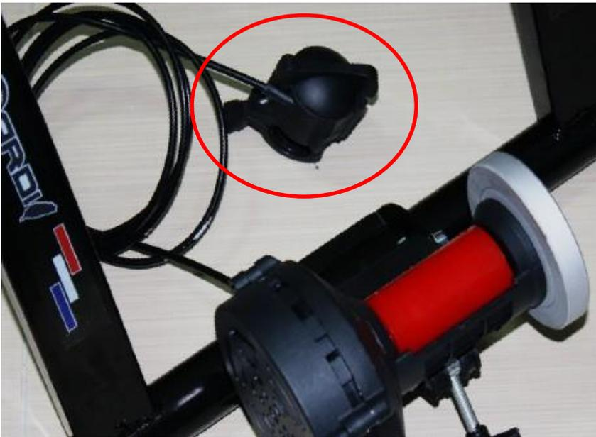
線控阻尼輕重調節器操作時，必須跟正常變速單車一樣，騎乘轉動時才能轉動操作(磁阻才會換檔變化)。若訓練台滾輪無轉動切勿轉動調節器，可能使調節器損壞
