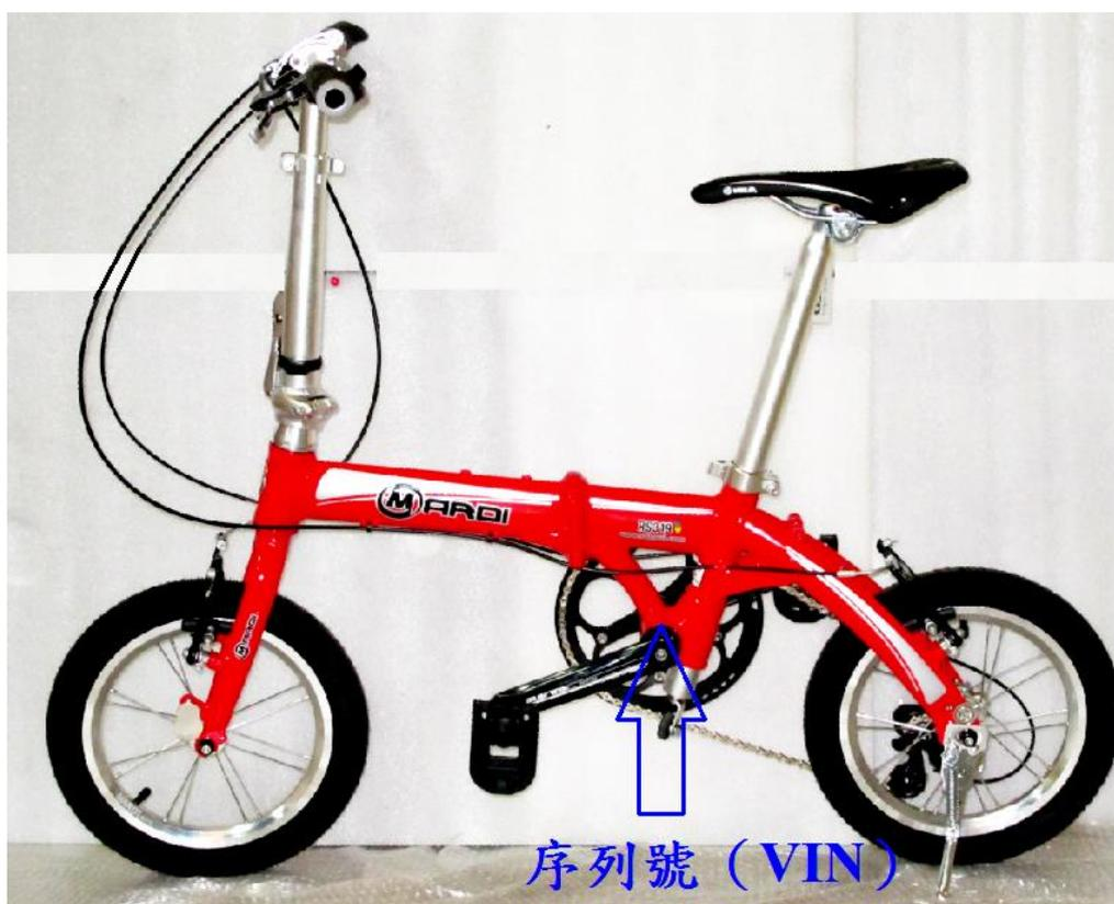
序列號 (VIN) 您可以在車架大盤上找到自行車的序列號，此編號可對自行車進行識別。
