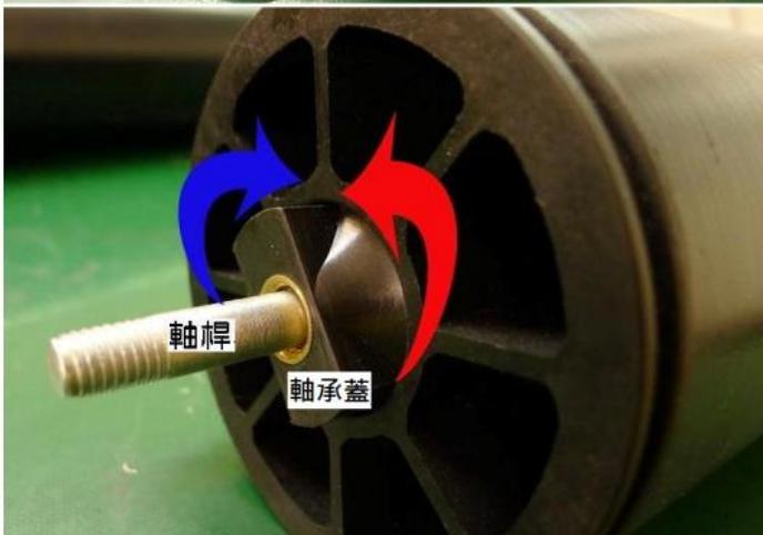
經過使用後，若滾輪產生跳動/晃動情形，可以旋轉兩側軸承蓋，以達到修正。
